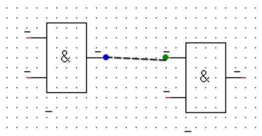
Les petits traits situés autours des éléments, permettent de nommer les éléments et leurs bornes, il est également possible de nommer les connexions :
